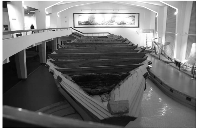
図13：「泉州湾古船陳列館」に展示の沈船。水密構造をもっていたことがよくわかる。
